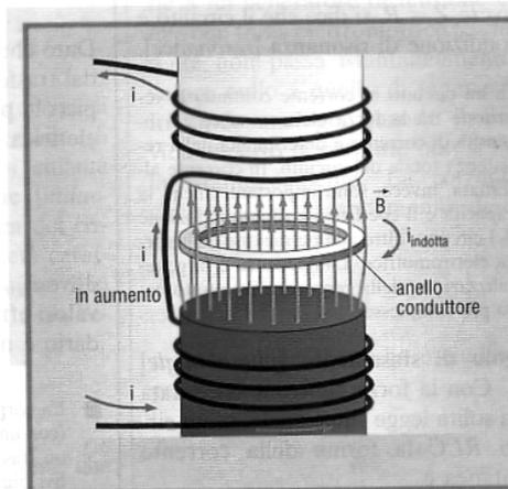
Figura 12.1. Un anello conduttore è situato tra i poli nord e sud di un elettromagnete in cui la corrente sta aumentando. La variazione del flusso magnetico fa circolare una corrente indotta nell'anello. Ciò significa che nei punti in cui si trova l'anello si è creato un campo elettrico diverso da zero.
